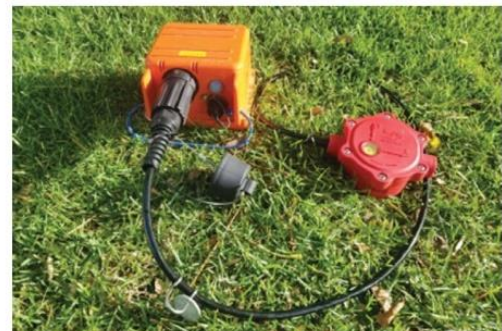
Атом-3С с трехосным геофоном 2 Гц.
