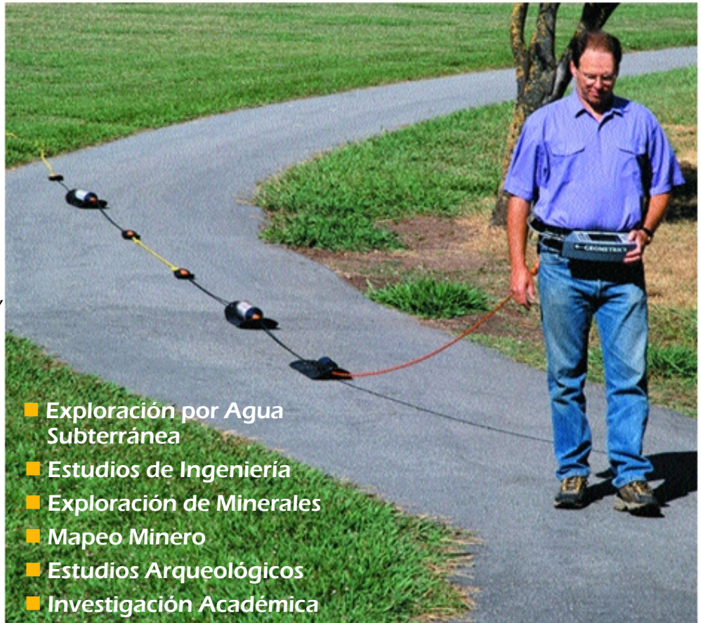
OhmMapper siendo arrastrado sobre pasto y pavimento. El contacto es hecho capacitivamente con el terreno a través de los cables aislados.
