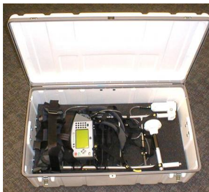
G-859 y GPS en caja de embarque reutilizable con acojinamiento y ruedas para traslado
